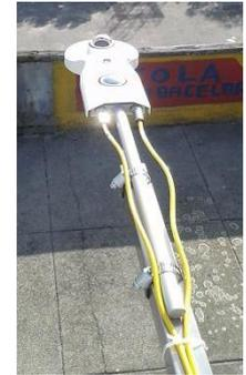
Medição temperatura, velocidade e direção do vento, precipitação, radiação solar, UV, ... (Estação meteorológica DAVIS)
