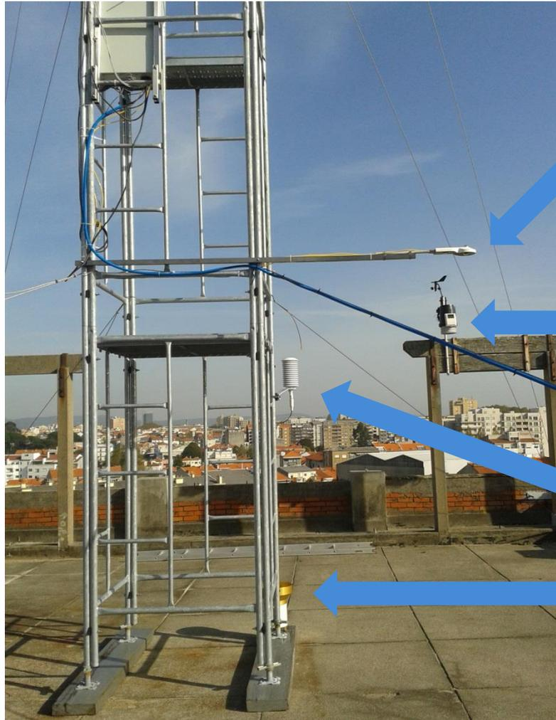
Balanço energético – Rad. Global, incidente e refletida; Rad. Infravermelha, incidente e terrestre (Radiómetro)
