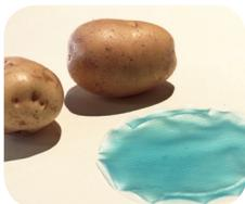
Vem fazer bioplástico, a partir da batata, e compreender as reações químicas envolvidas em cada passo do processo. O bioplástico é biodegradável e é produzido à base de amido, cujas propriedades permitem que se obtenham películas transparentes, resistentes à rutura, inodoras e sem sabor.
